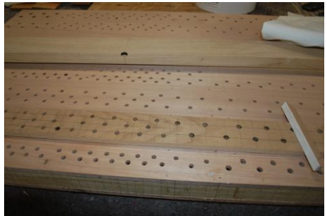
De splinternieuwe windladen die in het orgel zullen komen. De windladen zorgen voor luchttoevoer naar de orgelpijp. Op de windladen (in de gaatjes) komen de orgelpijpen te staan.
